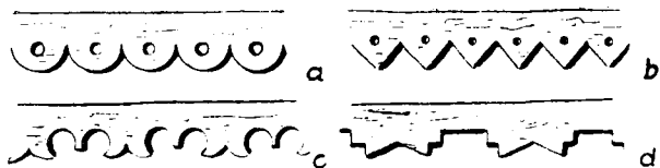
Ryc. 11. Ozdobnie profilowane listwy biegnące wzdłuż dłuższej ściany domu. a) Stropkowo, pow. Sierpc. b) Stropkowo, pow. Sierpc. c) Pacyna, pow. Gostynin. d) Mochowo, pow. Sierpc. Rys. Maria Data.
