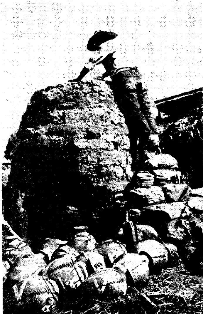
Ryc. 7. Wyjmowanie wypalonych naczyń z pieca garncarskiego w Aco
